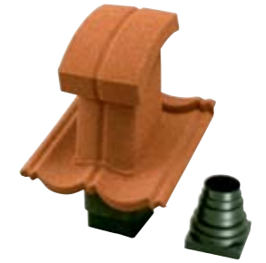
6 Decra ventilationshuv Multi 12°-30° eller 30°-50°. Levereras med anslutningsrör (150 x 150 mm) och övergångsstycke (Ø 100-150 mm).
