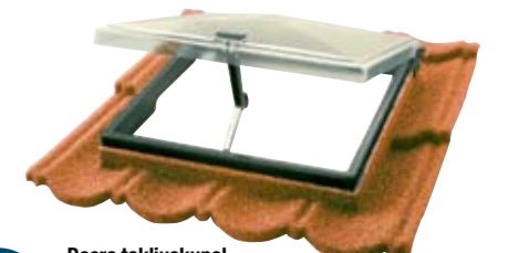
18 Decra takljuskupol Av slagtålig polystyrenplast. Ruta av akryl. Bygger 4 x 2 pannor. Öppningsmått 488 x 492 mm.
