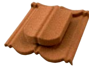
7 Decra ventilationspanna Multi Används för ventilation av utrymmet mellan Decrapannorna och undertaket där detta krävs (t ex vid långa takfall utan luftad nock).
