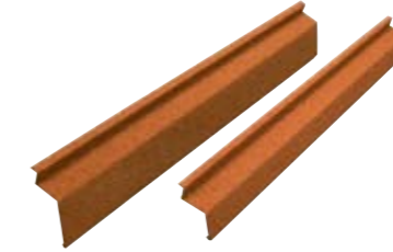
11 Decra fotstycke 15/25 Täcker 900 mm. Standard (h=55 mm). Renovering (h=95 mm). Nyttolängd 1100 mm.
