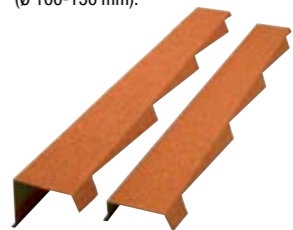
12 Decra profilerat vindskivebeslag (h=35 mm) För gavel med vindskiva. Decra profilerad gavelavslutning (h=100 mm) För gavel utan vindskiva. och vid renovering av eternittak. Höger/vänster. Nyttolängd: 3 rader pannor. Profilerarna är koniska.
